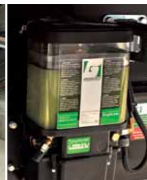
Čerpadlo centrálního mazání zajišťuje dobré mazací podmínky nejdůležitějších částí stroje. Dostupné ve dvou velikostech.
