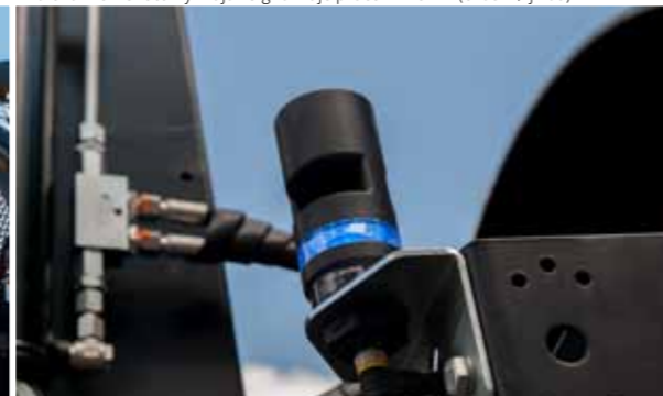
Multifunkční světelný maják signalizuje pracovní režim (třídění / jízda).
