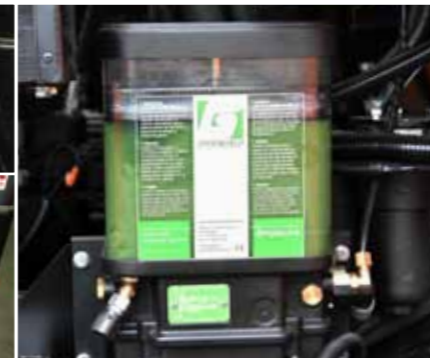
Čerpadlo centrálního mazání zajišťuje dobré mazací podmínky pro nejdůležitější části stroje.
