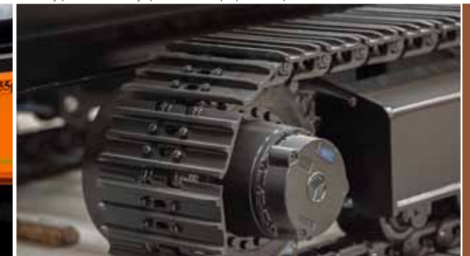
Pásový pohon umožňuje přemístování po pracovní ploše bez dalších tahačů.
