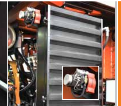
Systém Cleanfix automaticky čistí chladič motoru a hydraulického oleje.
