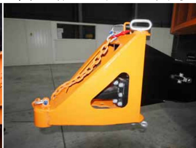
Kulový adaptér umožňuje přemísťování drtiče pomocí stavebních strojů, např. bagru.
