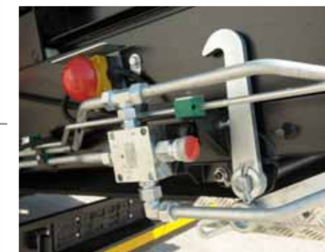
Regulace rychlosti posuvu podávacích dopravníků – umožňuje přizpůsobení rychlosti podle druhu prosévaného materiálu tak, aby byla maximálně využita nabízena kapacita mobilního bubnového třídiče. Umožňuje rovněž nahromadění většího množství materiálu každé frakce bez nutnosti přemístování stroje.
