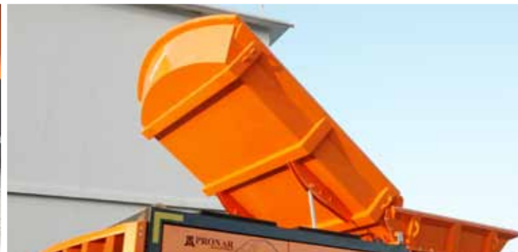
Hydraulicky zvedaný násypný žlab usnadňuje zavedení objemných materiálů do pracovní komory.
