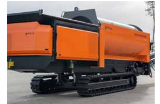
Systém hydraulického zvedání rámu MPB 20.55gh umožňuje vyrovnání stroje pro práci na podélných sklonech a zvyšuje světlost, což usnadňuje překonávání nerovného terénu.
