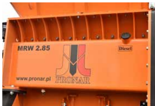
Pracovní komora je zhotovena z materiálů s vysokou odolností a odolných proti otěru, což významně prodlužuje životnost stroje.
