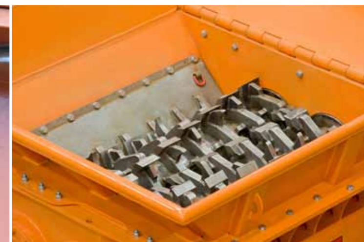
Drtilcí válce zhotovené z vysoce jakostní oceli zajišťují dlouhou životnost.
