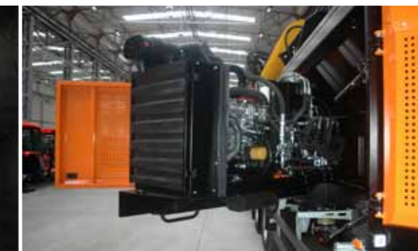
Motor a hydraulika jsou umístěny na otočném rámu, což umožňuje snadný přístup při údržbě.
