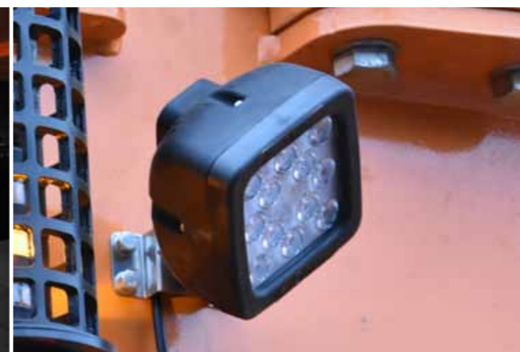
Pracovní osvětlení zvyšuje komfort při práci a bezpečnost v blízkosti drtiče.
