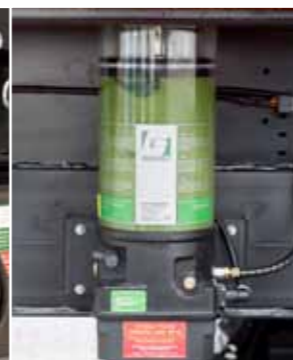
Čerpadlo centrálního mazání zajišťuje dobré mazací podmínky nejdůležitějších částí stroje. Dostupné ve dvou velikostech.
