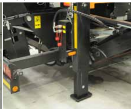
Hydraulické opěrné nohy zvyšují pohodlí obsluhy operátora a zajišťují větší stabilitu třídiče při práci.
