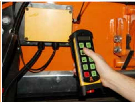
Dálkový ovládač umožňuje operátorovi regulaci pracovních parametrů stroje bez opuštění kabiny nakládače.
