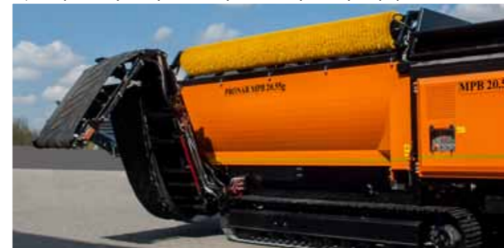
Dopravníky se skládají na vnější stranu stroje, což umožňuje snížení jeho výšky.
