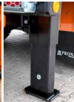
Hydraulické zadní opěrné nohy zvyšují stabilitu stroje při práci.
