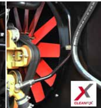
Systém Cleanfix automaticky čistí chladič motoru a hydraulického oleje.
