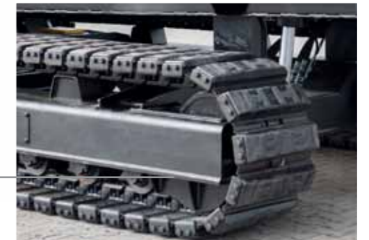
Systém hydraulického zvedání rámu MPB 20.55gh umožňuje vyrovnání stroje pro práci na podélných sklonech a zvyšuje světlost, což usnadňuje překonávání nerovného terénu.
