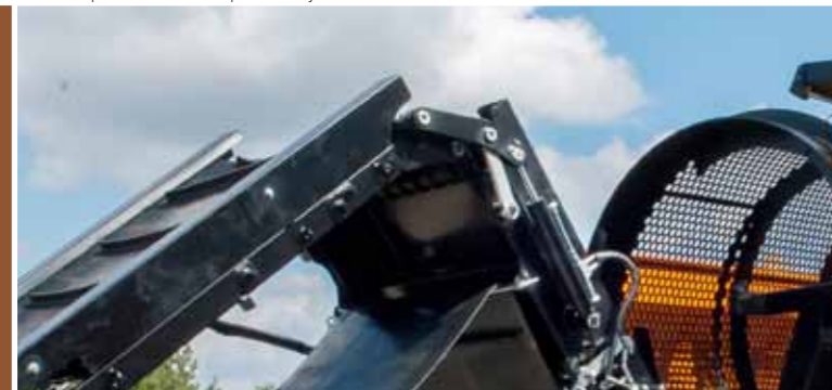
Zadní dopravník se skládá pomocí čtyř ovládačů.
