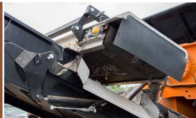
Hydraulicky ovládaný magnetický separátor odděluje ocel od rozdrčeného materiálu.
