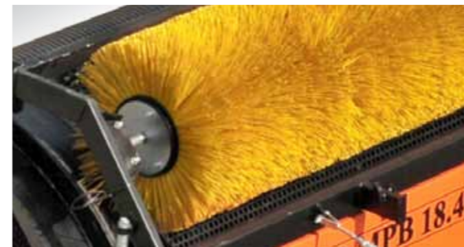
Kartáč pro čištění bubnu s hydraulickým zvedáním a spuštěním.
